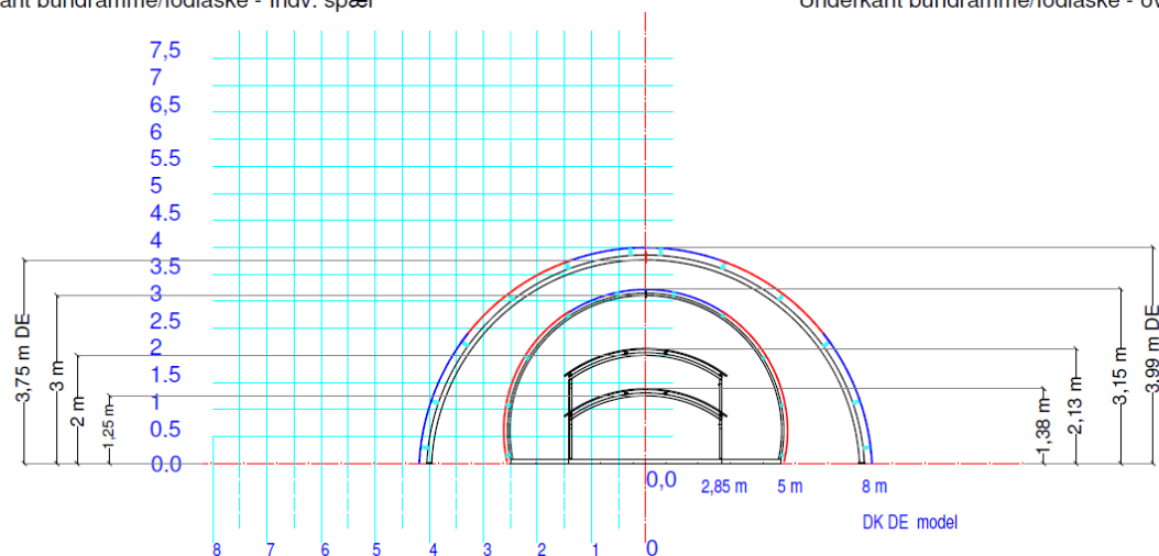
Figur 2. Højde tegning af rundbuehal. Planen viser forskellige modeller, den pågældende model har bredde på 5m og højde på 3,15m.
